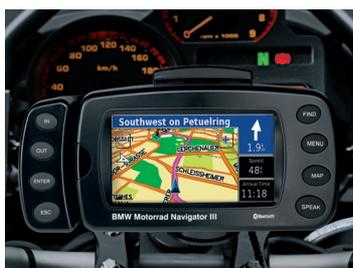
Der Bluetooth®-fähige **BMW Motorrad Navigator** bringt Sie sicher ans Ziel. Er verbindet vier Instrumente in einem: Routen- und Reiseplaner, GPS-Empfänger, Kompass und Tripcomputer. Darüberhinaus besitzt er u. a. eine Text-to-Speech Ansage, eine besonders leistungsfähige Satellitenantenne und vorinstallierte Kartendaten von ganz Westeuropa.
