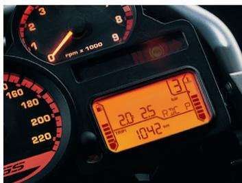
Das **RDC** (Reifendruckkontrollsystem) misst über Sensoren kontinuierlich den vorhandenen Reifendruck und informiert bei Unterschreitung der Grenzwerte den Fahrer über das Display bzw. über eine Warnleuchte.
