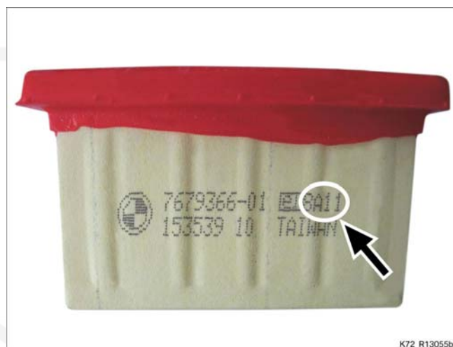
Abbildung: Luftfiltereinsatz mit kodiertem Produktionsdatum
